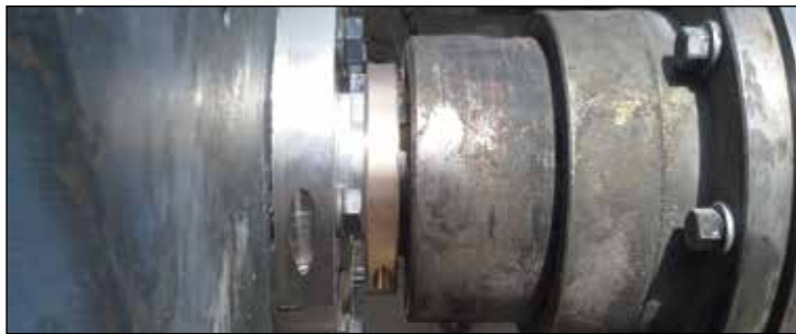
Ein speziell konstruierter Inpro/Seal Bearing Isolator in geteilter Ausführung bietet einen permanenten Lagerschutz für ein SAG-Mühlengerie in einer Kupfermine im Südwesten der Vereinigten Staaten.
