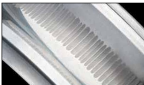
Wellenströme können Riffelungen in der Lagerlaufbahn verursachen, was zu einem vorzeitigen Lagerausfall führt.
